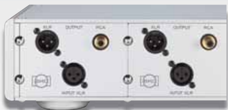
Der MCCI bietet nur symmetrische Eingänge (u.), ausgangsseitig gibt's XLR- und Cinch-Buchsen
