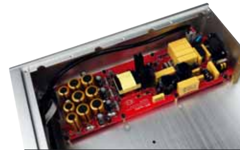
Hightech: Die Versorgung der MCCI übernimmt ein hochmodernes Schaltnetzteil, das sich exemplarisch ruhig verhält
